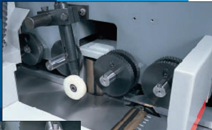
Grande precisione ed ottima qualità di finitura vengono assicurate dal sistema di traino automatico e dal piano macchina completamente rettificato. Per facilitare l'avanzamento e il caricamento di pezzi corti e sottili, la Syncro può essere equipaggiata, a richiesta, di rullo di traino supplementare in entrata.
