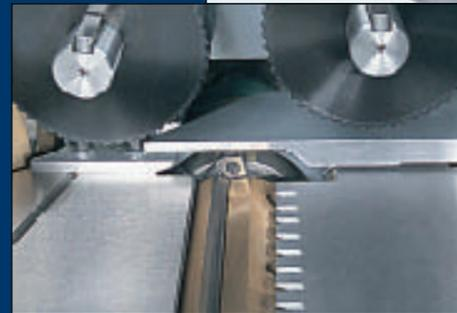
La fresa rasante, montata sull'albero pialla, e la relativa guida in uscita, permettono il perfetto raddrizzamento del pezzo in lavorazione.
