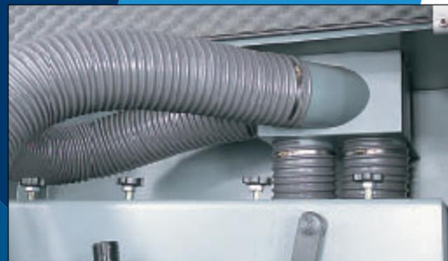
Il sistema di aspirazione centralizzata garantisce un perfetto scarico dei trucioli ed una più semplice ed economica installazione della macchina.
